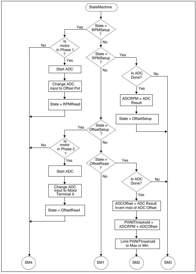
FIGURE A-7: MOTOR CONTROL STATE MACHINE
