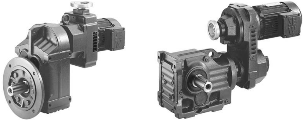
Afbeelding 17: Wrijvingswiel-variatormotorreductor VARIMOT ® met vlakke reductor en riem-variatormotorreductor VARIBLOC ® met kegelwielreductor
