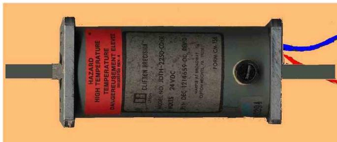
Avant de clore il est bon de rappeler que vous devez installer une diode de puissance en série entre votre dynamo CC et votre batterie afin d'éviter une décharge de votre batterie lors de NON vent ou de voir votre dynamo fonctionner en moteur au lieu de génératrice CC.
