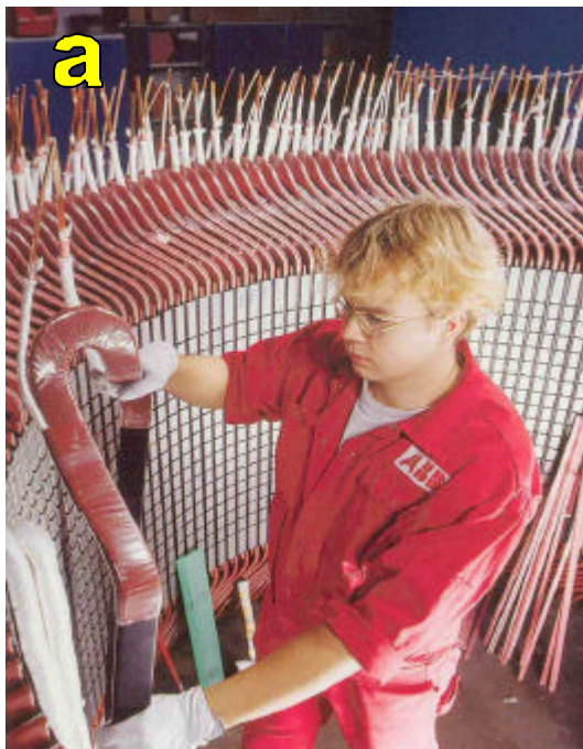
figuur 4.5 Voorgevormde spoelen voor een hoogspanningswikkeling (Foto ABB) a) Aanbrengen van de vormspoelen in de statorgleuven b) Afwerken van de wikkelpoppen met de uitlopers
