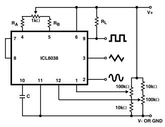
FIGURE 4. CONNECTION TO ACHIEVE MINIMUM SINE WAVE DISTORTION
