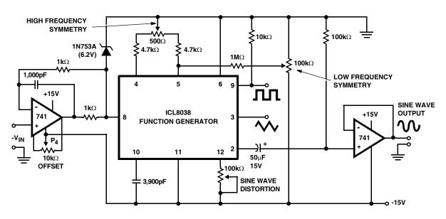
FIGURE 10. LINEAR VOLTAGE CONTROLLED OSCILLATOR
