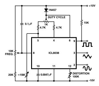
FIGURE 8. VARIABLE AUDIO OSCILLATOR, 20Hz TO 20kHzY
