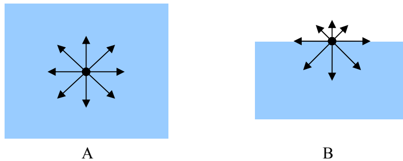
Fig. 1.7 Moleculen in een vloeistof en onderlinge aantrekkingskrachten: (a) binnenin de vloeistof en (b) aan de rand van de vloeistof.
