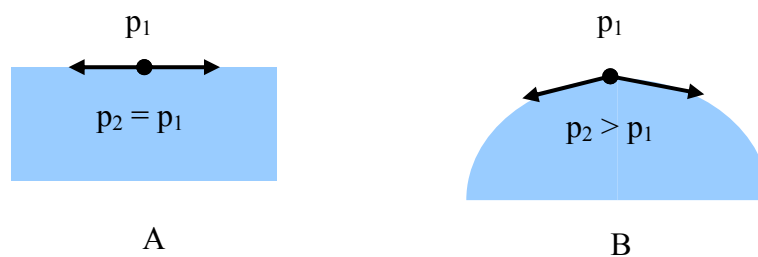
Fig. 1.8 Effecten van de oppervlaktespanning: (a) bij een vlak scheidingsoppervlak en (b) bij een gekromd scheidingsoppervlak.
