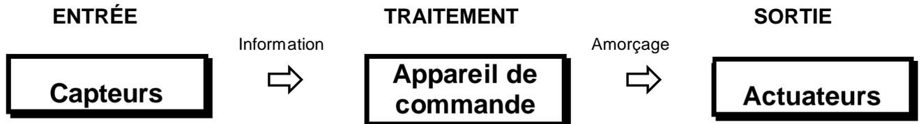
Les **organes d'entrées** sont les capteurs qu'on appelle aussi générateurs de signaux, sondes ou transducteurs de mesure.
