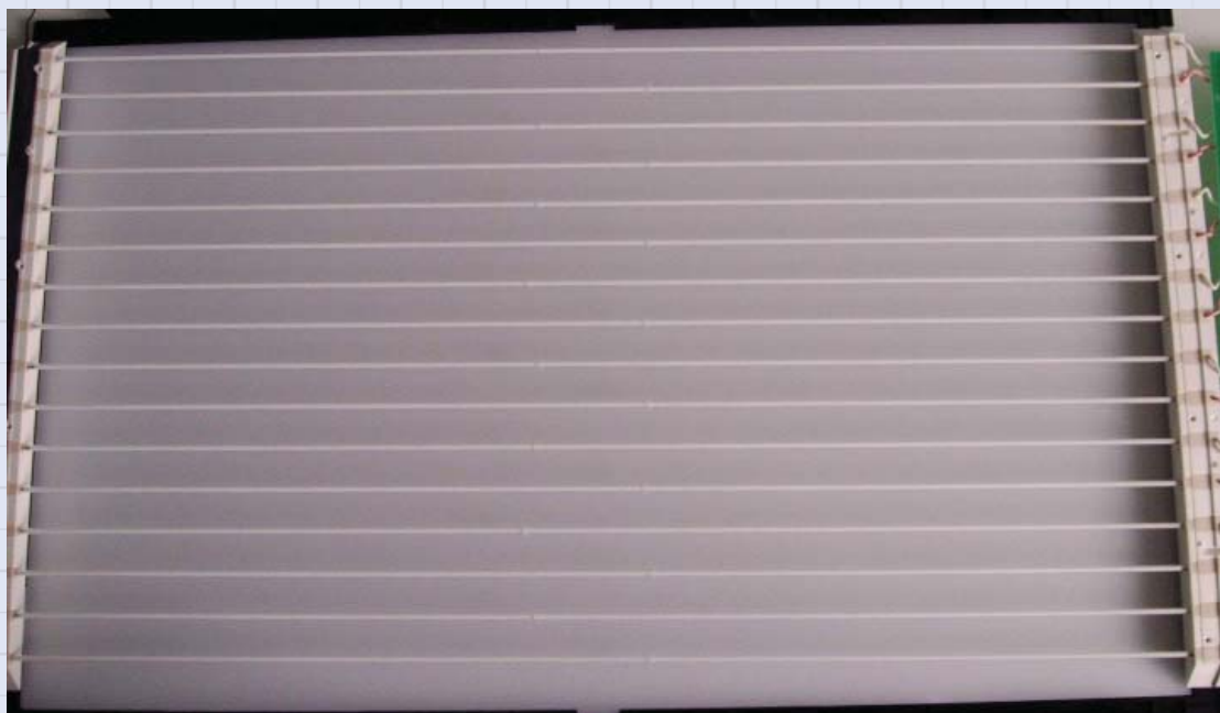
CCFL-Hintergrundbeleuchtung eines 32" LCD-Panels
