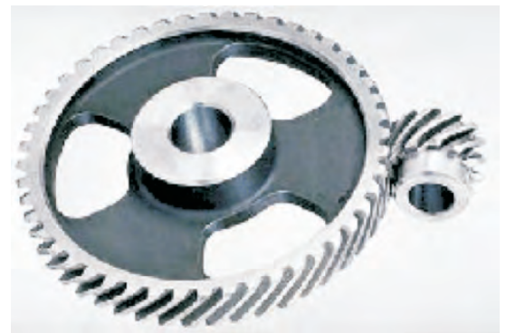
helicoïde overbrenging, schuine vertanding (45°), assen loodrecht
