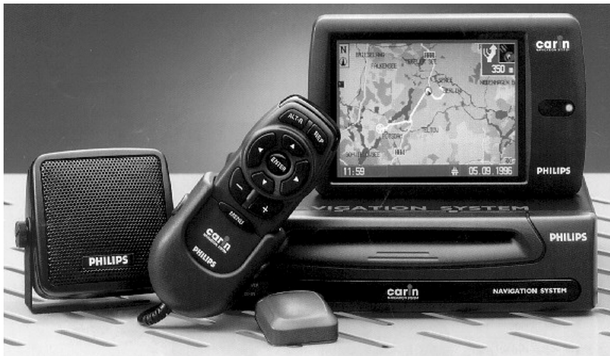
Figuur 5.5. Onderdelen van CARIN: navigatie systeem (inclusief GPS-ontvanger, CD-speler en gyro), monitor, luidspreker, afstandbediening en GPS antenne. De bestuurder wordt via de monitor en luidspreker geïnformeerd.
