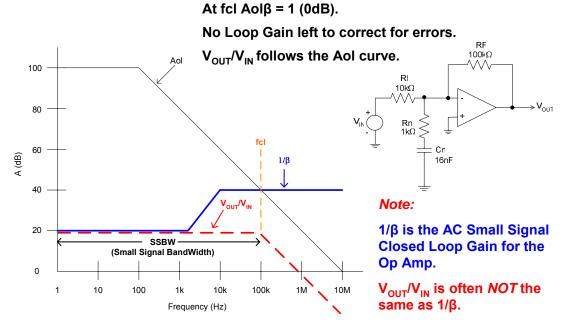
Fig. 1.23: V<sub>OUT</sub>/V<sub>IN</sub> Vs 1/β
