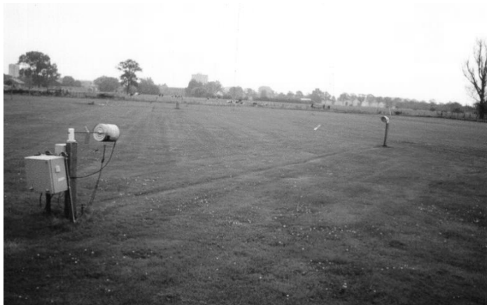
Figuur 8. Antenne-systeem op weerveld Leerstoelgroep Meteorologie en luchtkwaliteit. Het systeem bestaat uit een draad die geïsoleerd opgehangen is boven de grond. Vooral zichtbaar zijn de blikken die de isolatoren moeten beschermen tegen vocht.
