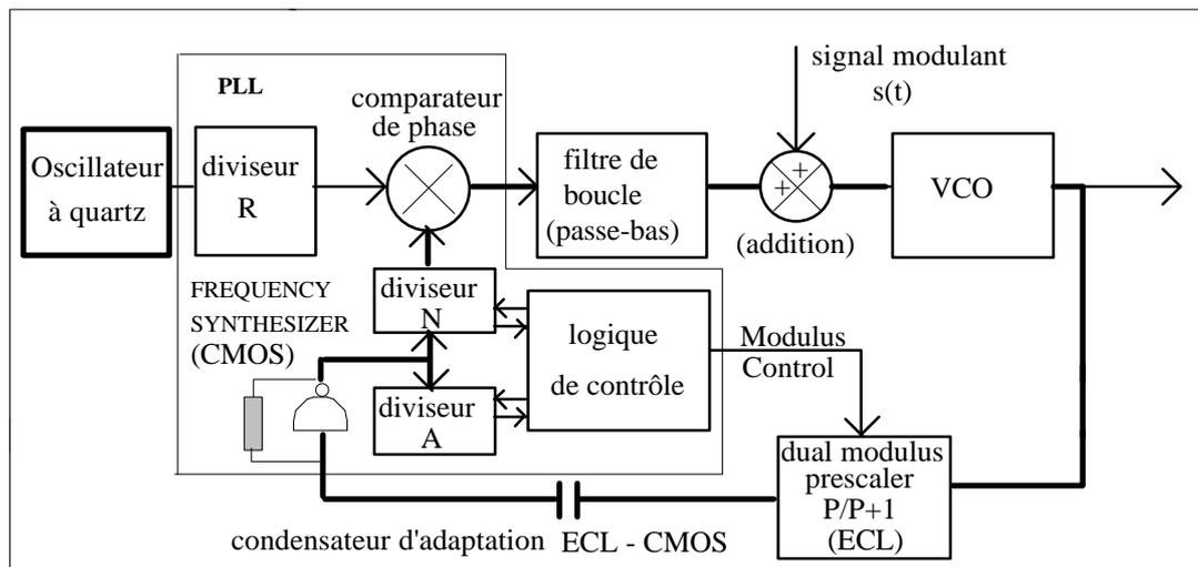
Fig. 33 Modulateur de phase à fréquence porteuse variable
