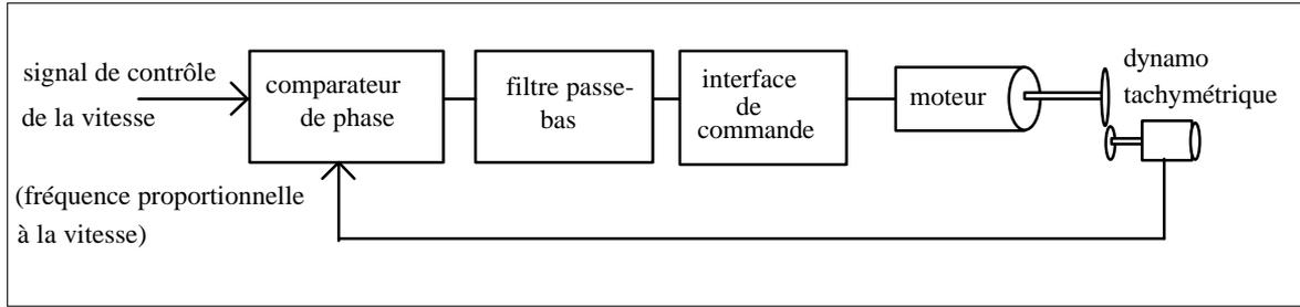
Fig. 40 Contrôle de vitesse par boucle à verrouillage de phase
