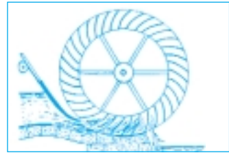
Fig. 6: Onderslagwaterraderen van het stoottype (a) en Poncelet-type (b) Bron: Mükler, Wagehett, e.a. Leipzig 1994
