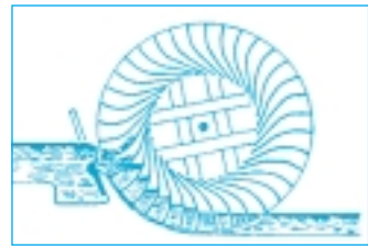
Fig. 5: Middenslagraderen (Sagebien (a) en Zuppinger (b)) en bovenslagrad (c) Bron: Mükler, Wagehett, e.a. Leipzig 1994
