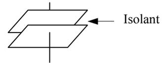
Pour les condensateurs, on appelle l'isolant un diélectrique.
