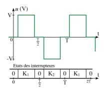
La forme d'onde obtenue avec une commande décalée est plus proche d'une forme sinusoïdale que les créneaux obtenus avec la commande symétrique.
