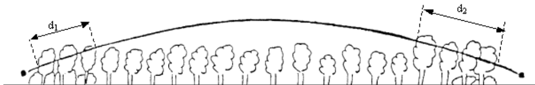
Figuur 10: de attenuatie te wijten aan propagatie door vegetatie neemt lineair toe met de propagatie-afstand d_f door de beplanting. d_f = d_1 + d_2 . De straal van het gebogen pad is 5 km
