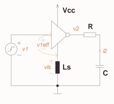
Example Parameter: •Vcc=5V •Tr=10ns •Tpd=15ns •Ls=40nH •C=100pF •R=10 $\Omega$   $vls = Ls \cdot \frac{dils}{dt}$
