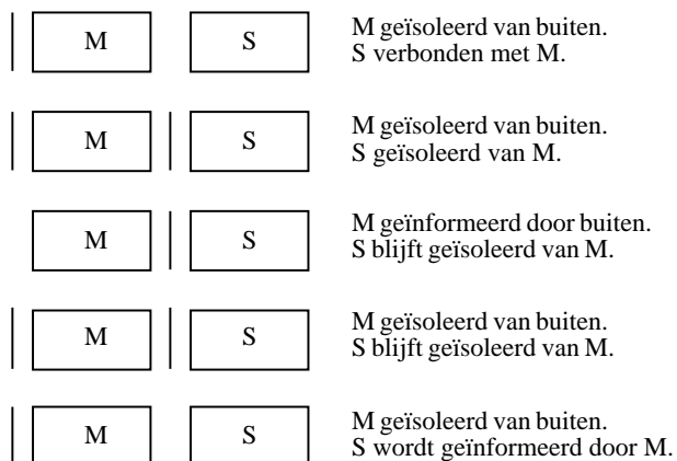
Figuur 11.2 Symbolische voorstelling van de werking van een MS/JK FF.
