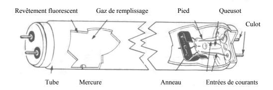
Les cathodes: Elles sont constituées par un fil de tungstène tri spiralé et enduites de substances alcalino-terreuses qui favorisent l'émission des électrons.
