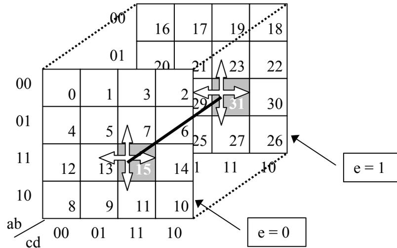
Le tableau peut être représenté par deux tableaux de 4 variables. La cinquième variable change de valeur lorsqu'on passe d'un tableau à l'autre. Deux cases, occupant la même position dans les deux tableaux sont adjacentes
