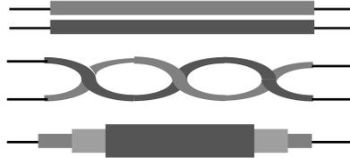
Le signal électrique se propage de la source vers la charge à une vitesse  $V$  (ou *célérité*) égale ou inférieure à la vitesse de la lumière  $c$  ( $c = 300.000 \text{ km/s}$ ). En pratique, on a toujours :  $V < c$  (typiquement  $200.000 \text{ km/s}$ ).
