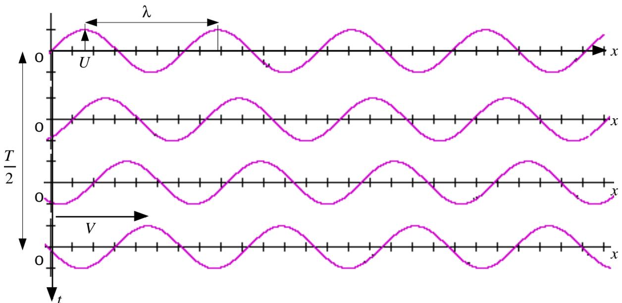
Equation horaire du signal en déplacement le long du câble : cette équation donne la tension en fonction du temps  $t$  et de la distance  $x$  à la source :  $u = U \sin [\omega(t - \Delta t)]$
