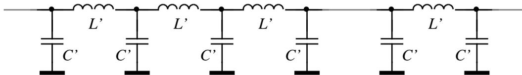
Le calcul de  $Z_c$  (cf § A12) pour un quadripôle symétrique en  $\Pi$  à constantes localisées ( $L'$ ,  $C'$ ), non résistif, conduit vers les basses fréquences à un résultat similaire à celui d'une ligne à constantes réparties :
