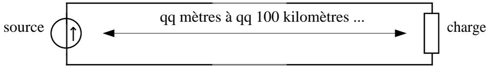
Une ligne de transmission par câble électrique comprend toujours deux voies. Si la ligne ne fonctionne pas en mode différentiel, la voie de retour est la masse.
