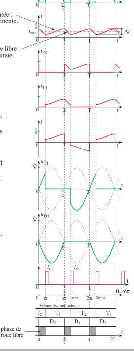
Niveau: Tet TS Cours: redressement commandé TP 🗸 Durée: 1 h Cours 🗸 Titre: pont mixte **Objectifs :** observer les oscillogrammes des tensions et des courants du montage dans différentes situations. iSchémas: LR  $D_2$  $i_{\mathrm{D}_1}$ Oscillogrammes: ŷ ŷ ŷ ŷ θ=ωτ θ=ωτ  $2\pi^{-2\pi+\alpha}$ |π+α  $2\pi$   $|2\pi+\alpha|$ π
