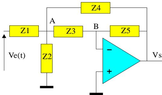
Les impédances  $Z_1$  à  $Z_5$  sont des résistances ou des condensateurs. L'amplificateur est supposé idéal. La réaction introduite par  $Z_5$  étant négative, l'amplificateur fonctionne en régime linéaire et  $V_B = V^+ = V^- = 0$ .
