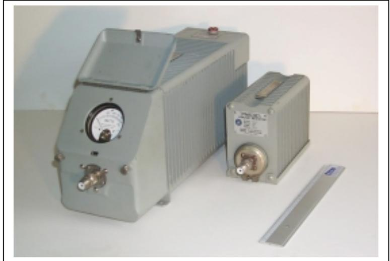
Enfin une variante de la charge est l'**atténuateur**, selon la même technique, on réalise un atténuateur (10 à 40 dB), ceci permet de récupérer une faible partie du signal pour le transmettre à un appareil de mesure (par exemple un fréquencemètre ou un analyseur de spectre).
