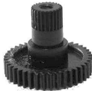
Figuur 13 Mechanische stop volledig verwijderd
