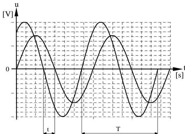
$$\varphi = \frac{360 \cdot t}{T} \quad \varphi \text{ [}^\circ\text{]}$$
