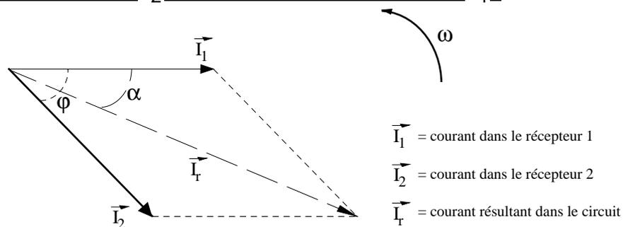
$\varphi$  déphasage entre  $I_1$  et  $I_2$ .  $\alpha$  déphasage entre  $I_r$  et l'axe d'origine.
