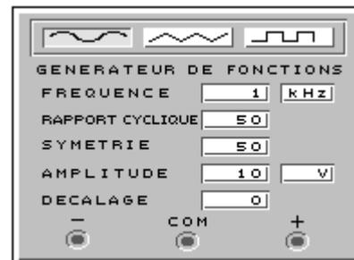
La puissance fournie par ce genre de générateur est très faible et ne convient pas pour alimenter une installation. Si nous désirons utiliser l'énergie fournie pour allumer une lampe ou faire tourner un moteur, il faut utiliser un autre genre de générateur. Pour cela, il est fait appel aux lois du magnétisme.
