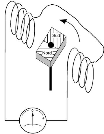
Avec ce genre de montage, nous produisons une tension alternative sinusoïdale. Les centrales de production d'énergie électrique sont équipées de génératrices qui fonctionnent selon le même principe, mais les générateurs sont de taille plus importante et ils sont appelés ALTERNATEURS.
