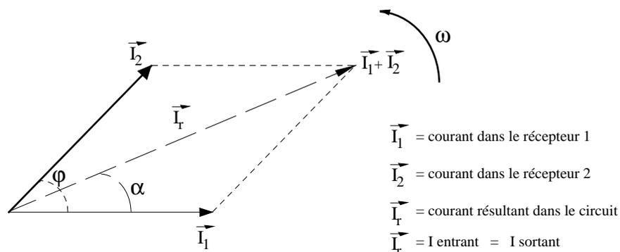
$\varphi$  déphasage entre  $I_1$  et  $I_2$ .  $\alpha$  déphasage entre  $I_r$  et l'axe d'origine.
