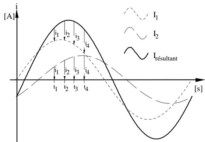
Il faut mesurer plusieurs valeurs instantanées des courants  $i_1$  et  $i_2$  et de les additionner. En reliant les points, nous obtenons une courbe représentant le courant résultant dans le circuit. Cette méthode a pour principal avantage de nous montrer la forme du courant résultant obtenu, ainsi que toutes les valeurs du courant instantané.
