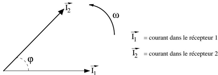
Le courant  $I_2$  est en avance sur  $I_1$ . L'angle  $\varphi$  détermine le déphasage.
