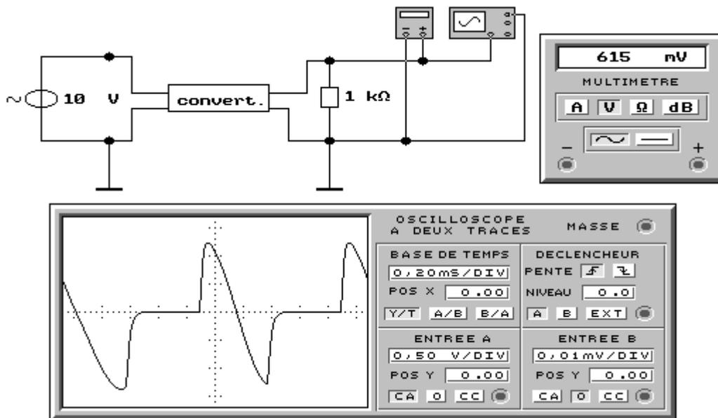
De même que pour les appareils commandés par des convertisseurs de fréquence, l'oscilloscope est le seul instrument capable d'effectuer une mesure correcte. L'oscilloscope nous montre la forme réelle du signal. Dans cet exemple, nous constatons que la tension indiquée par le voltmètre n'est pas identique à celle de l'oscilloscope.
