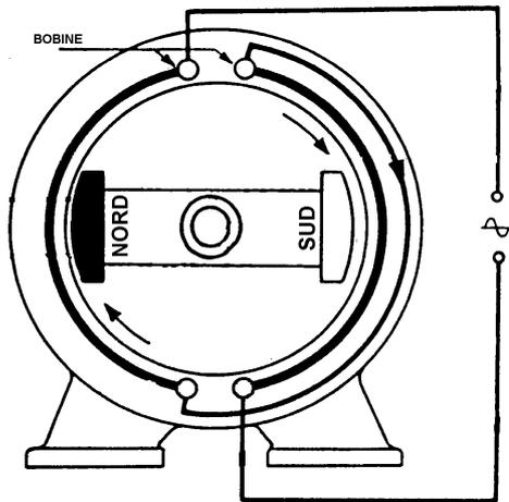
Un aimant permanent appelé ROTOR tourne au centre d'une carcasse.
