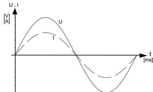
*$i = f(t)$  ou  $u = f(t)$  sont des représentations temporelles, puisque, dans le premier cas, il s'agit de représenter le courant  $i$  en fonction du temps  $t$ , et dans le second la tension  $u$  en fonction du temps  $t$ . De façon plus générale, représenter une grandeur en fonction du temps.*
